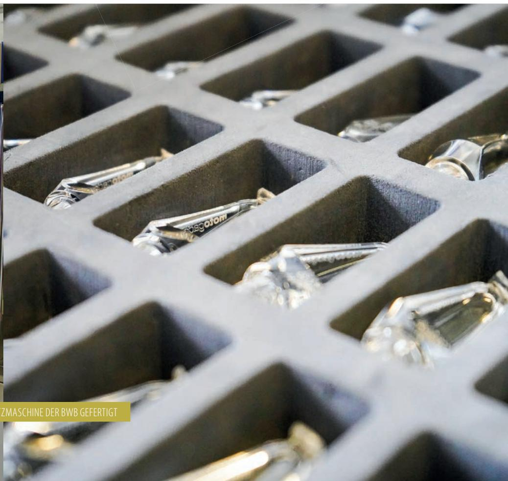
DER TRANSPARENTE KORPUS DES BLINKERS WIRD IN EINER SPRITZMASCHINE DER BWB FERTIGT
