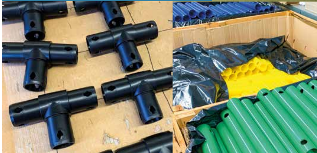
AUS EINER SOLCHEN SPRITZGUSSMASCHINE KOMMEN DIE FERTIGEN KUPPLUNGEN
